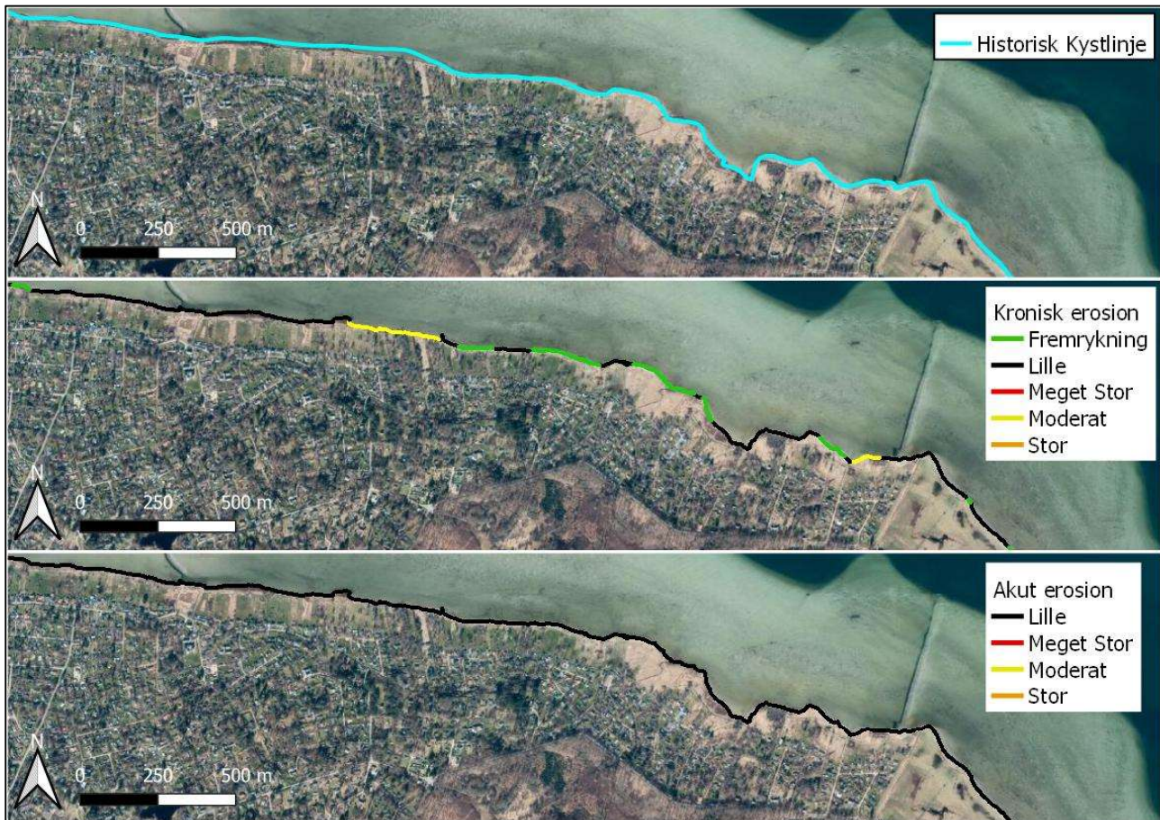
Figur 2.4: Historisk kystlinje fra ca. år 1885, kronisk og akut erosion i projektområdet, se ref. [9].
